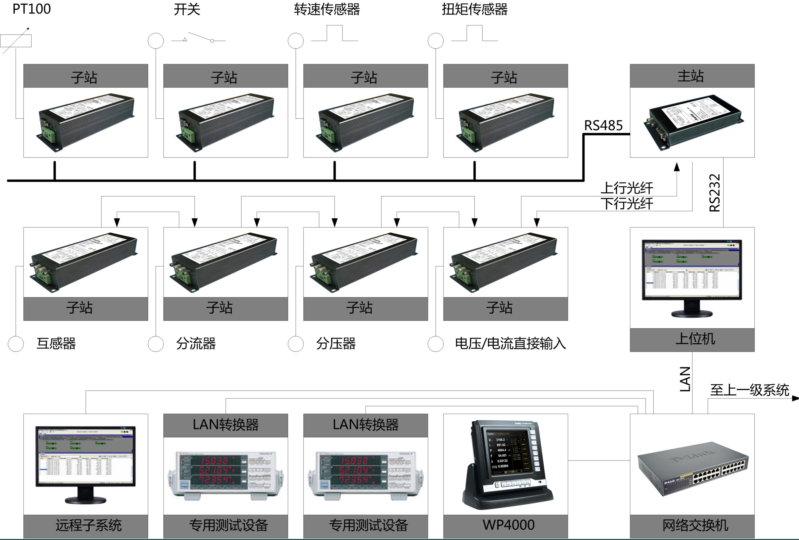
DCCS2009分布式测控系统拓扑图
