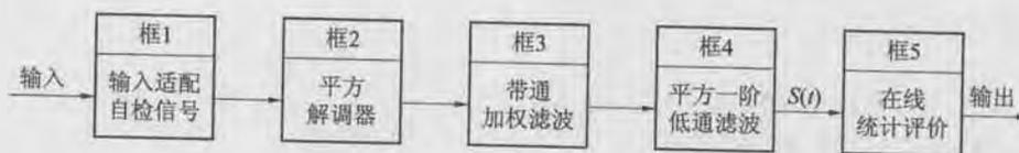
图 1 闪变测量环节示意图
